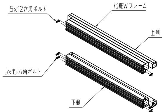
化粧Wフレームの溝にM5×12、M5×15六角ボルトを図のように挿入する。上下で取付数、ボルト長さが異なるので注意すること。
