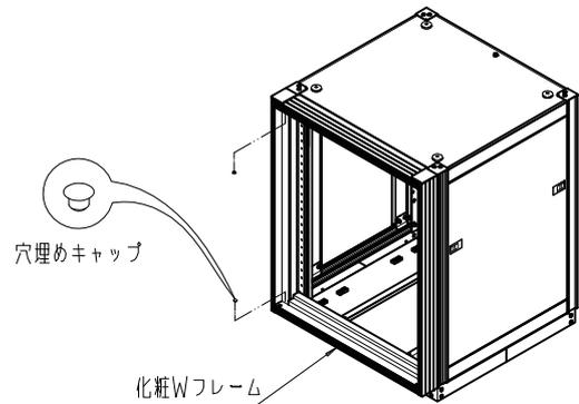
化粧Wフレームのドア軸と反対側に「穴埋めキャップ」を図のように挿入する。
