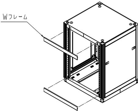
RKCキャビネットラックのドアを取り付ける側の「Wフレーム」をM5ボックスドライバーにて取り外す。
