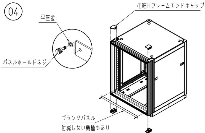
化粧Hフレームの上下に化粧Hフレームエンドキャップを取付ける。下側キャップにはアロンアルファを塗布する。ブラックパネルをパネルホルドネジと平座金にてラックに取付ける。
