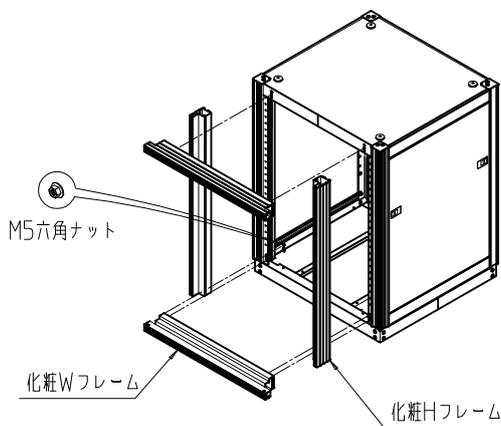
化粧HフレームをラックのHフレームに嵌めこみ、化粧Wフレームを六角ナットにて取り付ける。
