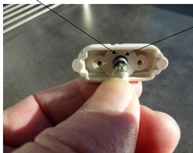
小さな隙間は、クランピングプレート※の先端を入れるのに役立ちます。
