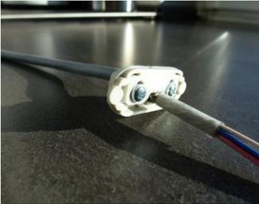
ケーブルが固定される程度に両方のネジを締めて固定されるように調整してください。
