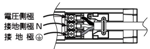
端子ネジ締付けトルク： $1.8\sim 2.0\text{N}\cdot\text{m}$
