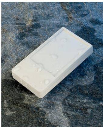
PMMA樹脂は赤外線透過します
