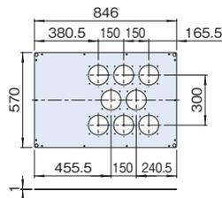
※危険防止の為、フィンガード(RAFM-A120)を取り付けてください。ファンモーターを取り付けない開口部にはファンモーターグロメット(RAFM-118FG-B)またはファンプレートカバー(RAFM-120APB)を取り付けてください。
