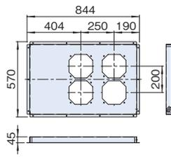
※危険防止の為、フィンガード(RAFM-180C-S)を取り付けてください。ファンモーターを取り付けない開口部にはファンプレートカバー(RAFM-180AKZ)を取り付けてください。
