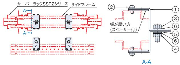
連結ラック間に5mm隙間を設ける場合(ラック間は600/700/800mm)
