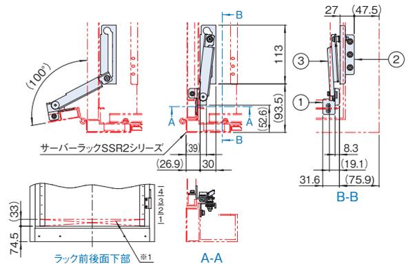
※1 ラックの最下部の1U部分に19インチ製品等を取り付ける場合、パネルマウントフレームのラック前後位置や19インチ製品の形状等によっては、ステーに干渉する場合がありますのでご注意ください。
