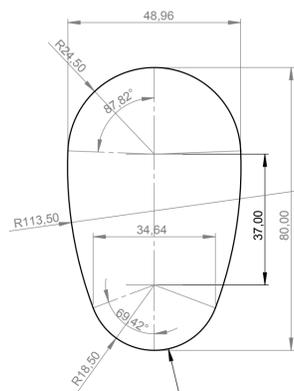
Beschnittkontur einer Frontfolie cut of a front foil
