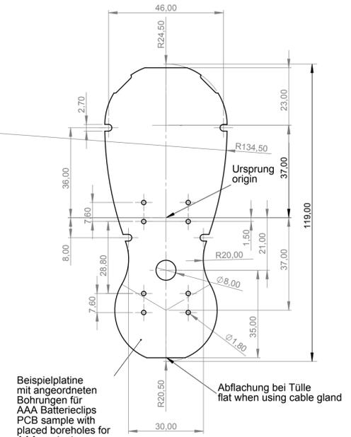
Beispielplatte mit angeordneten Bohrungen für AAA Batterieclips PCB sample with placed boreholes for AAA contacts
