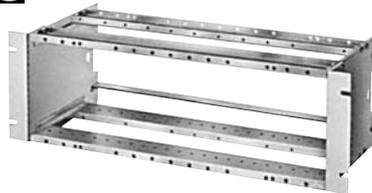
19インチカードラック (マガジン) でJIS C 6010-2に準じます。構成部品には一部アルミニウム押出型材を用いているほか、鉄板を用い、カードガイドRFG-1Pを使用します。本カードラック (マガジン) はカードファイル (プラグインユニット) RFUシリーズを格納する役目を持っています。
