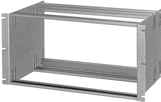
19インチサブラックでJIS C 6010-2に準じます。構成部品にアルミニウム押出形材とアルミニウム板を用い、カードガイドIGCシリーズを使用します。FBCシリーズへの取り付けに必要なカードガイドが別途用意されています。PCBの高さ寸法に合わせてWフレームの高さ調整ができ、コネクタの取り付けについては、コネクタフレームの位置調整ができるようになっています。PCBの収納最小間隔は5mmピッチで、この整数倍の収納間隔で設定していただくことができます。また5mmピッチであることからマザーボードを使用される場合におきましても便利です。
