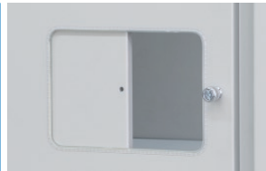
窓をスライドさせ、任意の位置でねじ固定できます。全閉時は、両側からのねじ固定により片側方向からは開口できません。
