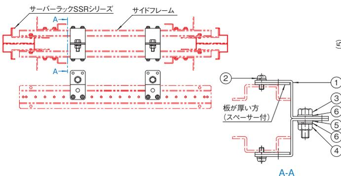
連結ラック間に5mm隙間を設ける場合(ラック間は600/700/800mm)
