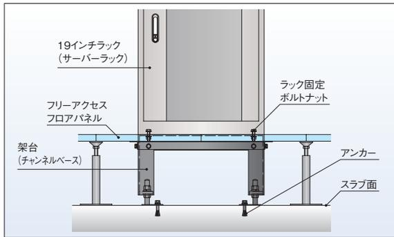
フリーアクセスフロアのスラブ面(床)に架台(チャンネルベース)をアンカー固定し、その架台に19インチラックを固定する方法です。
