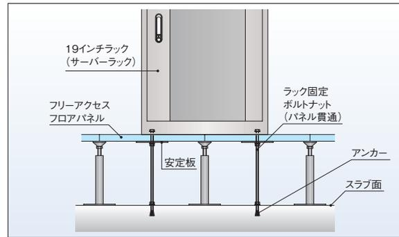
フリーアクセスフロアのスラブ面にアンカー固定したボルトに対して、パネルと19インチラックを共に固定する方法です。
