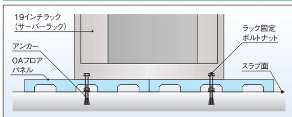
フロアのスラブ面にアンカー固定したボルトに対して、OAフロアパネルを通して19インチラックを固定する方法です。
