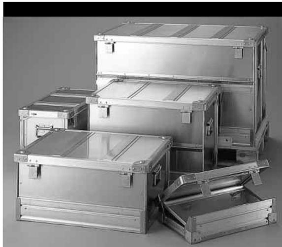
軽量・堅牢でありながら、折りたたみ構造を持ったユニークなアルミニウムコンテナです。耐熱性・耐腐食性に優れており、しかも折りたたむと体積が40%(最小27%)になり空間をより有効に利用できます。
