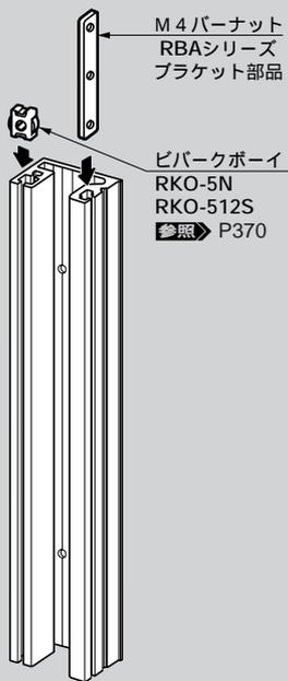
互いに奥行き寸法の異なるサポートアングルRKO- SA 参照 P420 などを実装する際にサイドフレームRKO- SF 参照 P138に取付けます。
