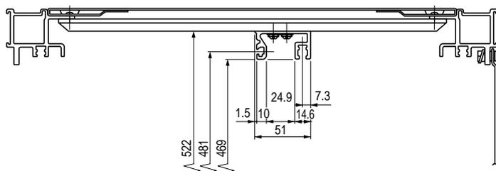
スライドレールC- 参照 P394 ~ P398やサポートアングルRKO- SA 参照 P420を実装する際、これらが短いと後端がリヤHフレームに届きません。これら後部のマウントに使用します。本オプションはサイドフレームRKO- SF 参照 P138を用いて取付けます。
